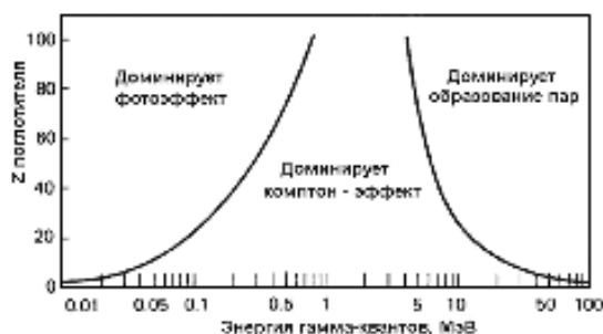
Рис. 5. Относительная ность трёх основных типов взаи- модействия \gamma -излучения с веще- ством. Кривые показывают значе- ния Z и E_\gamma , для которых соот- ветствующие сечения для двух смежных эффектов одинаковы.
