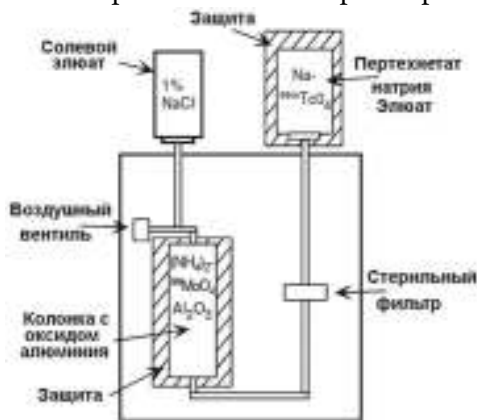
Рис. 9. Схема медицинского генератора технеция.
