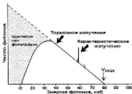
Рис. 12. Типичный энергетический спектр фотонов рентгеновской трубки при напряжении 80 кВ.
