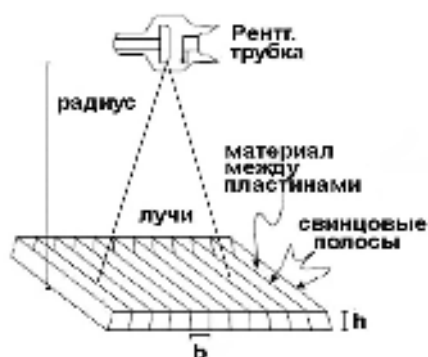
Рис. 16. Применение рассеивающей решетки для подавления комптоновского рассеяния и увеличения контраста изображения.
