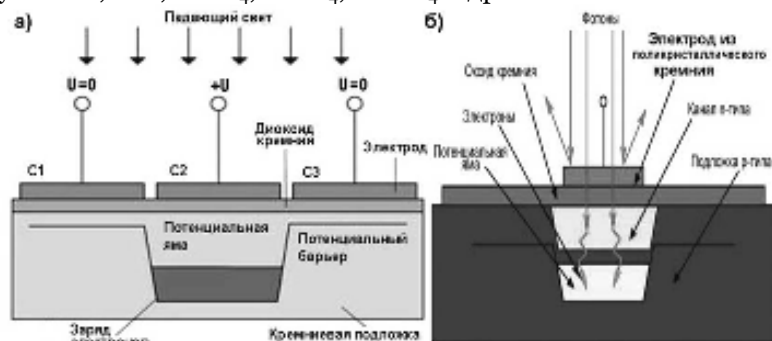
Рис. 8. Прибор с зарядовой связью. а – схема матрицы прибора с зарядовой связью (ПЗС): символами С1, С2 и С3 обозначены МОП-конденсаторы (металл-оксид-полупроводник). Если пиксели выстроены в один ряд, то приёмник называется ПЗС-линейкой, если же участок поверхности заполнен ровными рядами – тогда приёмник называется ПЗС-матрицей; б – сечение пикселя ПЗС-матрицы.
