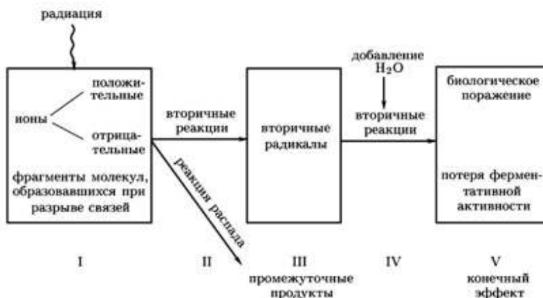
Рис. 3. Свободнорадикальная модель радиационного повреждения сухих ферментов: I – спектр первичных продуктов; II – процессы, протекающие на физико-химической стадии; III – образовавшиеся промежуточные продукты; IV, V – конечный эффект – потеря ферментативной активности.
