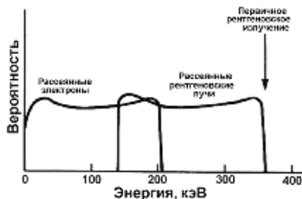
Рис. 4. Энергетическое распределение рассеянных \gamma -квантов и электронов при комптоновском взаимодействии 364-кэВ \gamma -лучей. Максимальное количество энергии, которое 364 кэВ рентгеновский квант может передать электрону в этом процессе равно 210 кэВ.
