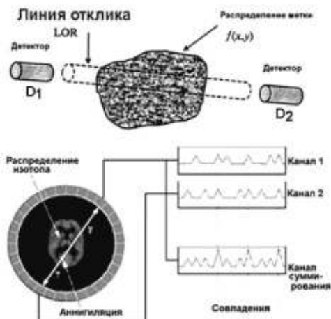
Рис. 6. Схема совпадений в ПЭТ-камере.
