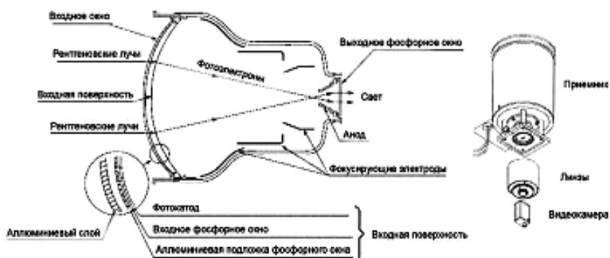
Рис. 5. Принципиальная схема рентгеновского электронно-оптического преобразователя.
