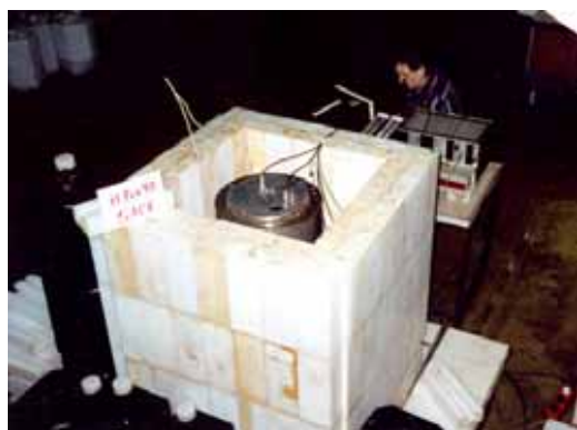
Рис. 4. Спектрометр для измерения потока быстрых нейтронов (лаборатория GGNT).
