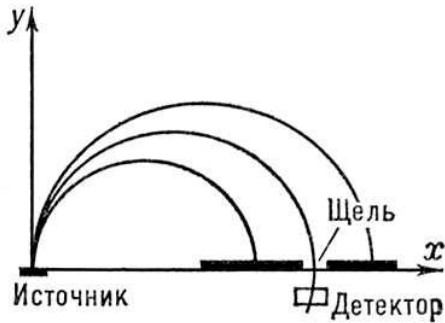
Рис. 6. Траектория электронов в \beta - спектрометре со счётчиком Гейгера-Мюллера. Плавно изменяя магнитное поле, к щели спектрометра последовательно подводят частицы с разными значениями импульса p .
