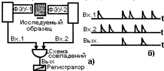
Рис. 17. Исключение шумов ФЭУ методом совпадений.
