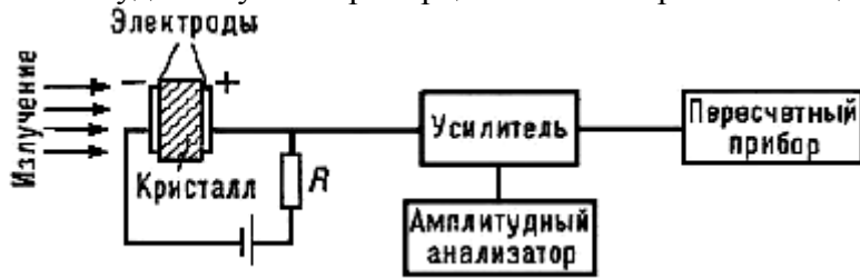
Рис. 26. Блок-схема кристаллического счётчика, работающего в импульсном режиме
