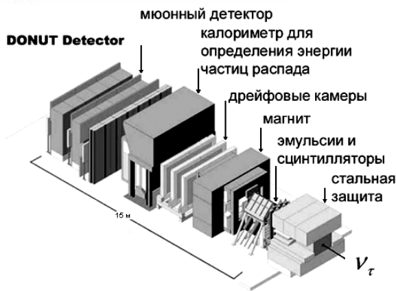
Рис. 9. Общая схема детектора DONUT
