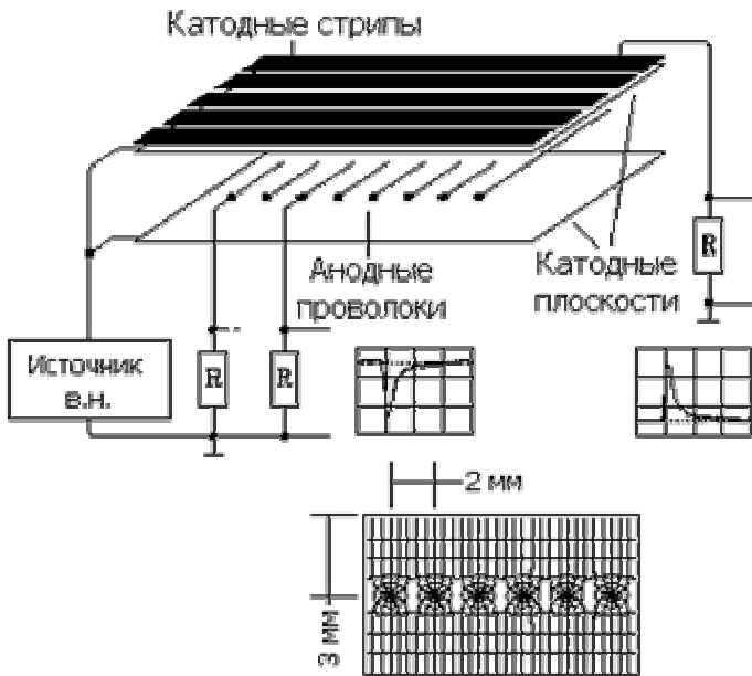
Рис. 28. Устройство многопроволочной пропорциональной камеры.
