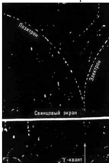
Рис. 7. Образование пары позитрон-электрон в камере Вильсона. Видны следы позитрона и электрона, образовавшихся при взаимодействии \gamma -кванта (не оставляющего видимого следа) с ядром свинца в свинцовом экране, перегораживающим камеру).
