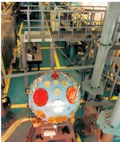
**Рис. 13.** Взрывная камера создаваемой в России установки инерционного термоядерного синтеза «ИСКРА-6». Со всех сторон в камеру будет вводиться 128 лучей, генерируемых фиолетовым лазером на стекле с неодимом. Импульс длительностью 3 нс будет нести энергию 300 кДж, длина волны лазера - 350 нм. На сегодня уже построены и используются в экспериментах четыре лазерных канала (установка «Луч») с энергией в импульсе 12 кДж.
