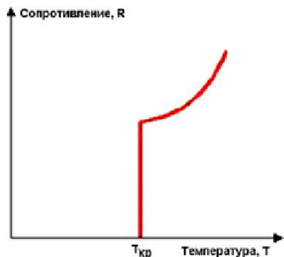
Рис. 33. Зависимость сопротивления материала (металла или керамики) от температуры.
