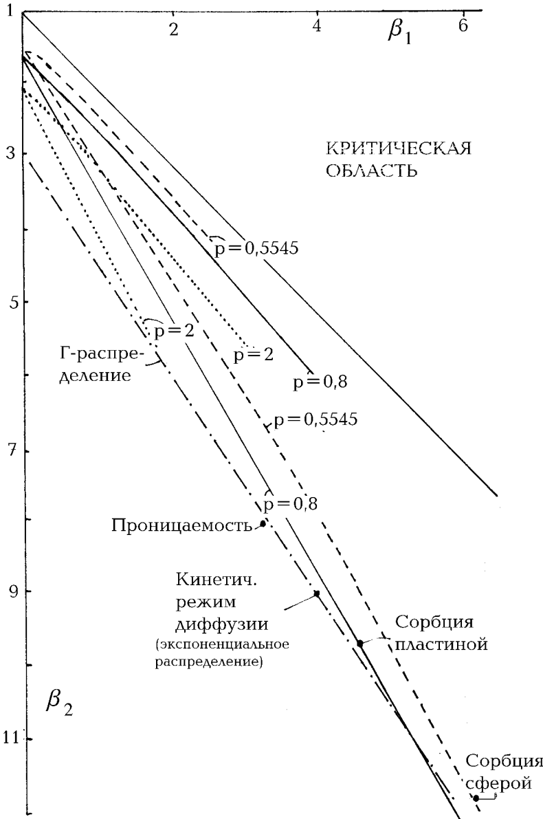
Рис.16. Подгонка основных моментов от кинетической кривой сорбции к стандартному статистическому распределению V(p,q) . Линии p=C_0 .
