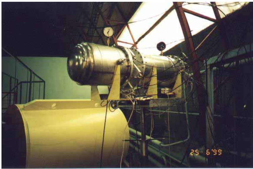
Рис. 17. Две ионизационные камеры деления, стоящие на пучке быстрых нейтронов № 5. Первая камера содержит слои с актинидными веществами, используется в работе "Neutron induced fission cross-sections of ^{233}\text{U} , ^{238}\text{U} , ^{232}\text{Th} , ^{237}\text{Np} and ^{239}\text{Pu} relative to ^{235}\text{U} from 1 MeV to 200 MeV". Вторая - содержит слои natPb и Bi, используется в работе "Neutron induced fission cross-sections of lead and bismuth relative to ^{235}\text{U} in the energy range 30 - 200 MeV".
