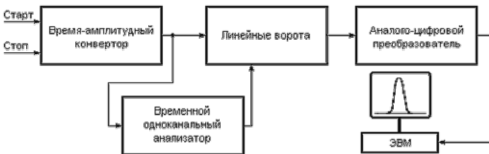
Рис. 20. Блок-схема, используемая для настройки двойных совпадений при использовании сочетания ВАК + одноканальный анализатор.
