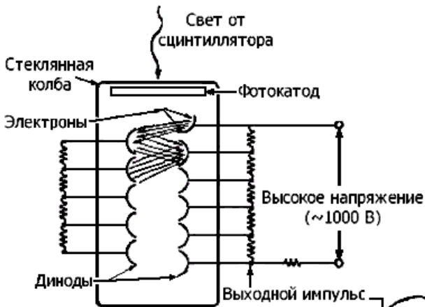
Рис. 9. Устройство ФЭУ.
