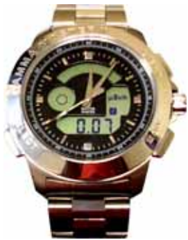
Рис.26. Часы со встроенным счётчиком Гейгера-Мюллера.
