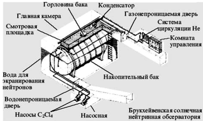
Рис. 17. Схема хлор-аргонного эксперимента
