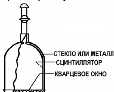
Рис. 11. Простейшая сцинтилляционная камера для измерения концентрации радона (Ячейка Лукаса).
