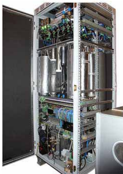
Рис. 5. Анализатор радиоактивных изотопов ксенона («АРИКС-02»), работающий в автоматическом режиме и предназначенный для эксплуатации на международных станциях радионуклидного мониторинга в системе Договора о контроле за прекращением ядерных испытаний.
