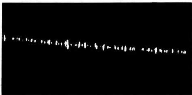
Рис. 26. Следы частиц в стримерной искровой камере
