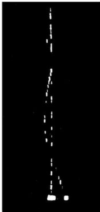
Рис. 25. Трек частицы в узкоззорной искровой камере.
