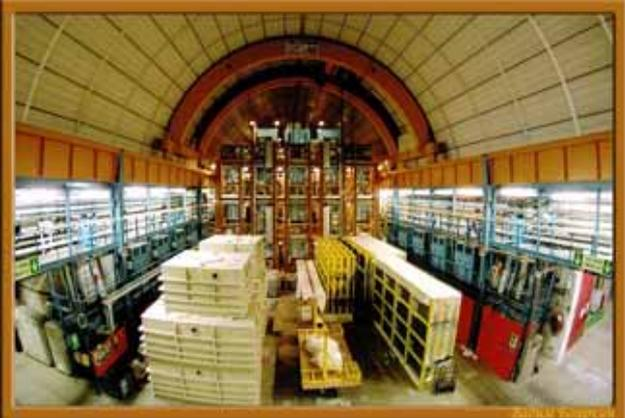
Эксперимент по регистрации нейтринного излучения от сверхновых проводится в Лаборатории Гран Сассо на установке *LVD* (Large Volume Detector - детектор большого объема). Установка *LVD* предназначена для исследований в области нейтринной физики, астрофизики, физики космических лучей и поиска редких процессов, предсказываемых теорией, но, как было обнаружено в последние годы, может быть использована и в ядерной геофизике для предсказания землетрясений.
