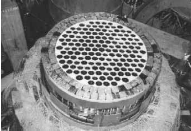
Рис.39а. Матрица кремниевого полупроводникового детектора, состоящая из 151 детектора диаметром 29 мм, высотой 100 мм.
