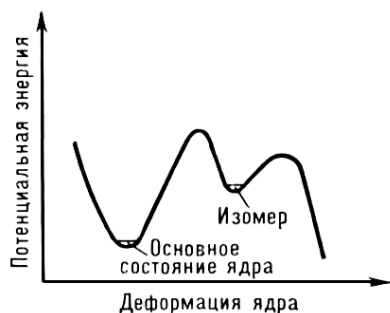
Рис. 12. Предполагаемая форма потенциального барьера в случае спонтанного деления из изомерного состояния. По оси абсцисс отложена степень отклонения ядра от сферической формы (степень вытянутости).
