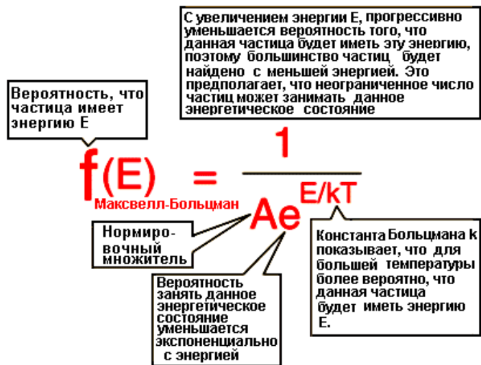
Рис. 21. Функция, описывающая распределение частиц по энергиям в предположении реализации закона Максвелла-Больцмана.
