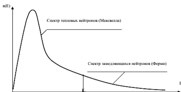
Рис. 6. Граница тепловых и замедляющихся нейтронов - энергия сшивки энергетических спектров Максвелла и Ферми.
