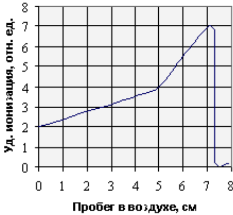
Рис. 3. Изменение удельной ионизации при торможении \alpha -частиц в воздухе (кривая Брэгга).
