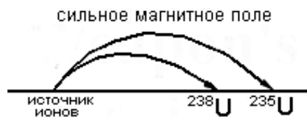
Рис.7. Схема метода электромагнитного разделения.
