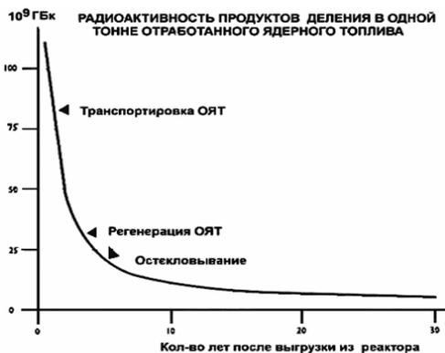
**Рис. 264.** Динамика изменения радиоактивности отработанного ядерного топлива, после извлечения его из реактора (малые времена).
