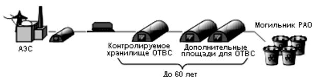
**Рис. 246.** Разомкнутый (открытый) ядерный топливный цикл
