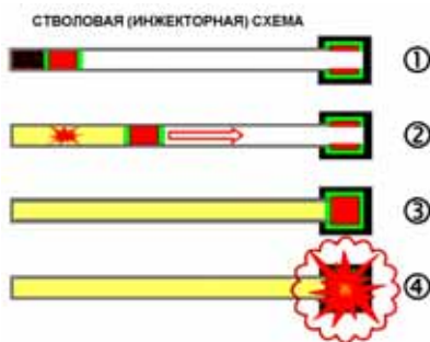
Рис. 240. Стволовая схема в действии. Соединение заряда и интенсивное облучение его нейтронами вызывает цепную реакцию, в результате которой в первую же секунду температура возрастает до 1 миллиона градусов.
