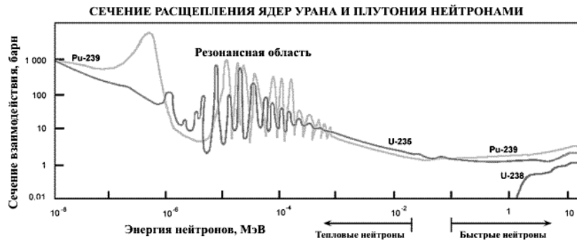
Рис. 232. Сечение деления ядер урана и плутония нейтронами.
