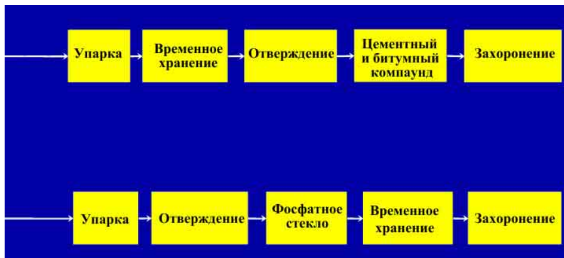
Рис. 21. Схема отверждения ВАО.
