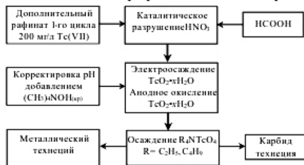
Рис. 20. Схема получения технеция и его монокарбида при электрохимической переработке дополнительного рафината ПУРЕКС процесса.
