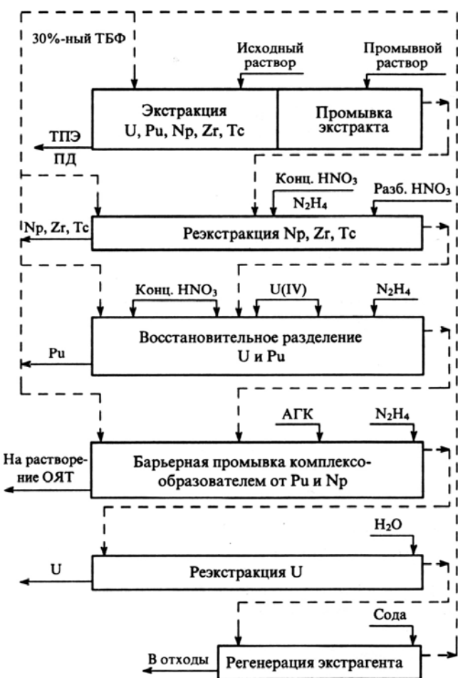
Рис. 7. Схема 1-го цикла переработки ОЯТ АЭС в процессе SuperPUREX.
