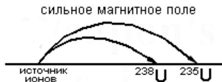
**Рис.7** Схема метода электромагнитного разделения
