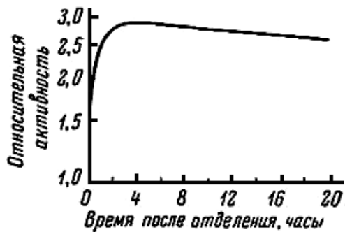
Рис. 7. Изменение во времени \alpha -активности радона-222 после отделения его от радия.
