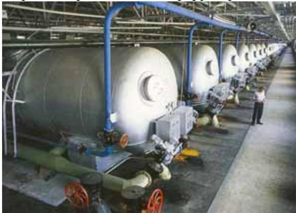
**Рис. 74.** Ёмкости на радиохимическом производстве где происходит процесс экстракции урана и плутония трибутилфосфатом (извлечение делящихся материалов из жидкой смеси органическим растворителем). Такая ёмкость взорвалась в 1993 на СХК.
