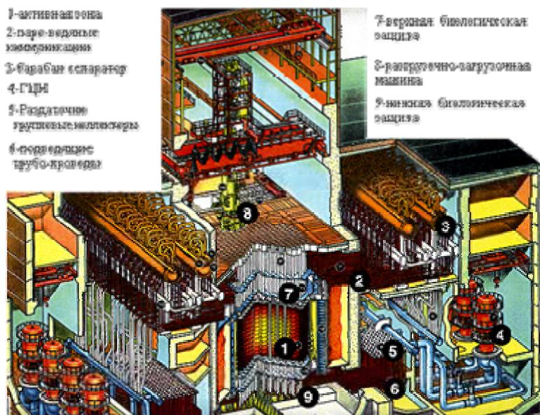
Рис. 68. Разрез реактора РБМК-1000.
