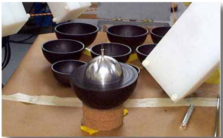
Рис. 29. Никелированная сфера нептуния, использовавшаяся в экспериментах по определению критической массы нептуния-237.
