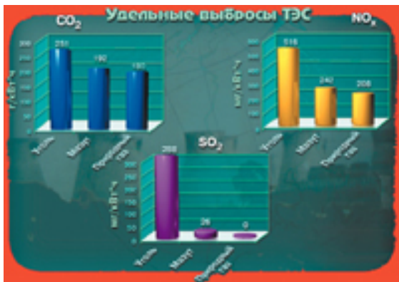
Рис.1. Удельные выбросы ТЭС, работающих на угле, мазуте и природном газе.
