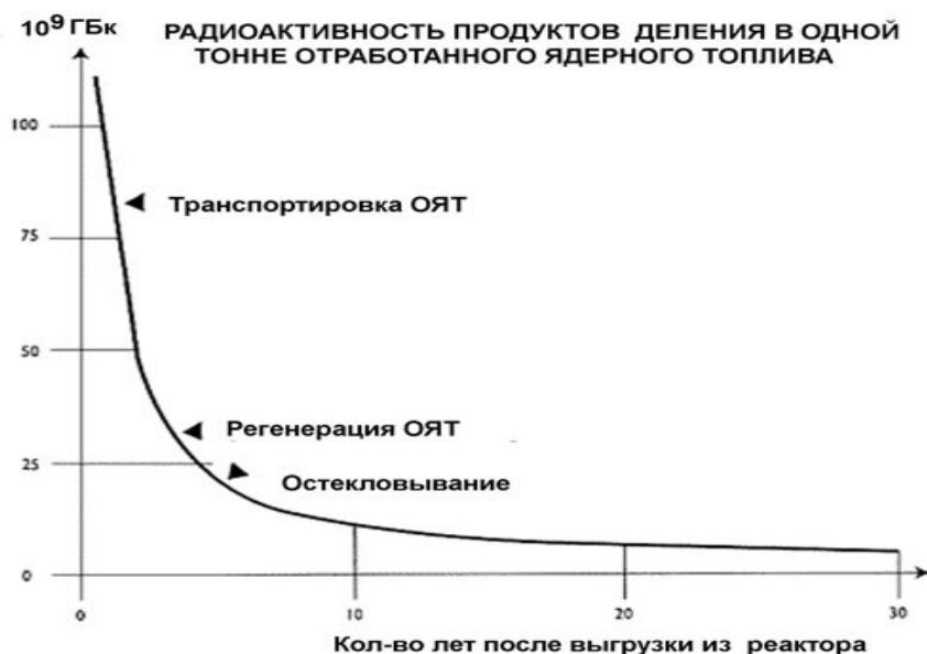
Рис.4. Динамика изменения радиоактивности отработанного ядерного топлива, после извлечения его из реактора (при хранении на территории АЭС).
