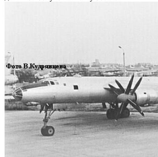
**Рис.16** Летаящая атомная лаборатория на базе самолета ТУ-95
