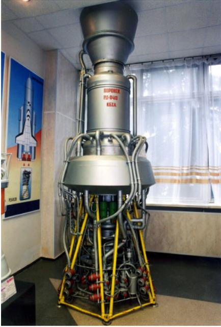
мощность 200 МВт, температуру газа 3200К, время непрерывной работы 10 минут и при этом излучал  $2 \times 10^{15}$  н\*см<sup>2</sup>/с. Экспериментальный РД-0410 имел тягу 3,6 т при массе (вместе с радиационной защитой и рамой крепления) 2 т. Выигрыш очевиден.
