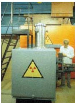
**Рис.14** Лабораторный реактор АРГУС
