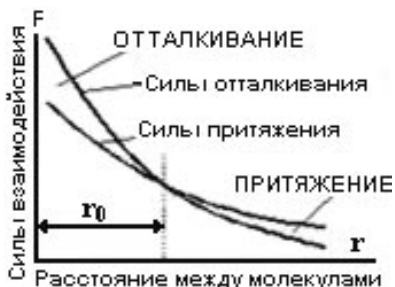
Рис. 11. Зависимость от расстояния сил отталкивания и притяжения между молекулами газа (сумма даёт потенциал взаимодействия, в котором обязательно присутствует минимум энергии).
