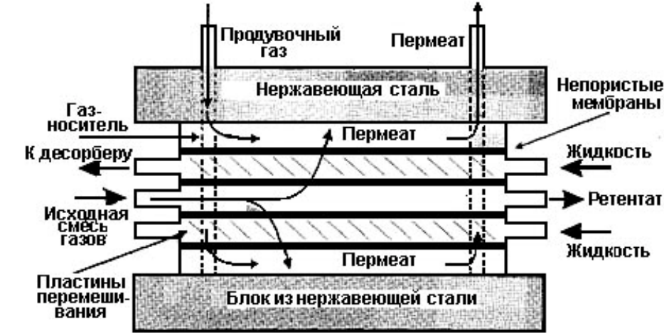
Рис. 18. Функционирование модуля пермеатора в селективном мембранном вентиле.
