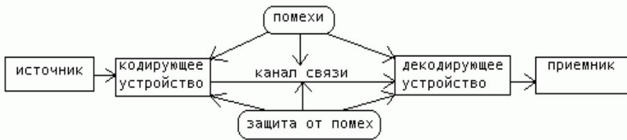
**Рис. 2.** Схема информационного канала
