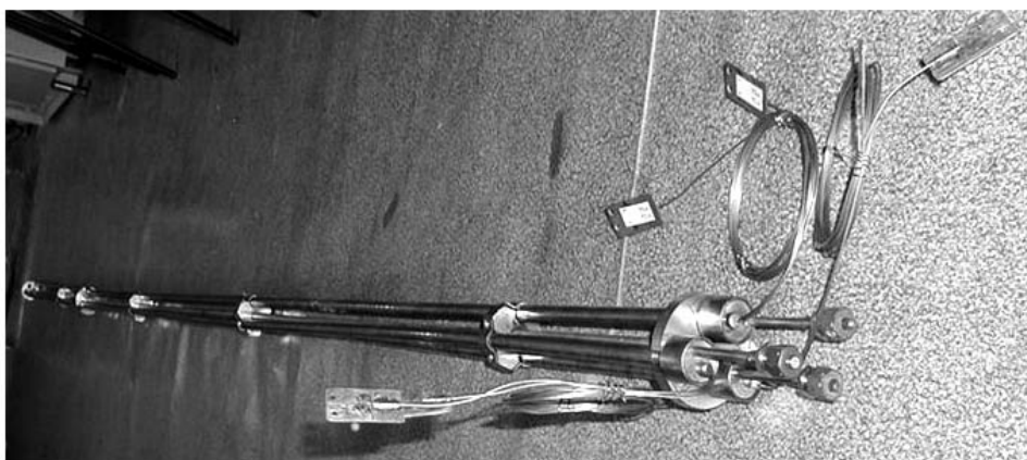
Рисунок 36 - Диффузионная ячейка и ампульная сборка длительного облучения образцов литиевой керамики
